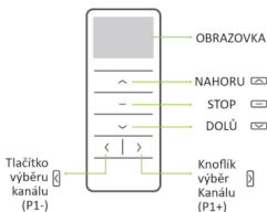
DD2712H – přenosný dálkový ovladač – 15 kanálů
