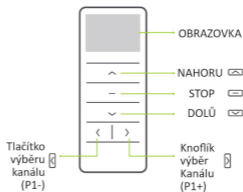
DD2712H – přenosný dálkový ovladač – 15 kanálů
