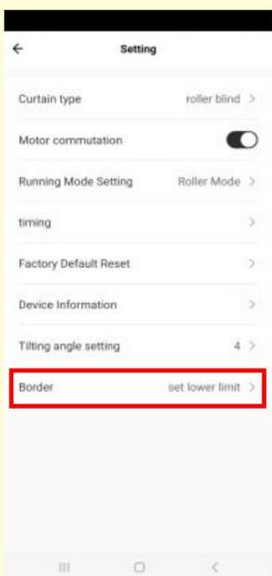
8. Klikněte na tlačítko Border pro vstup do nastavení limitního spínače ("upper", "lower" - dolní, "delate" - reset nastavení koncového spínače)
